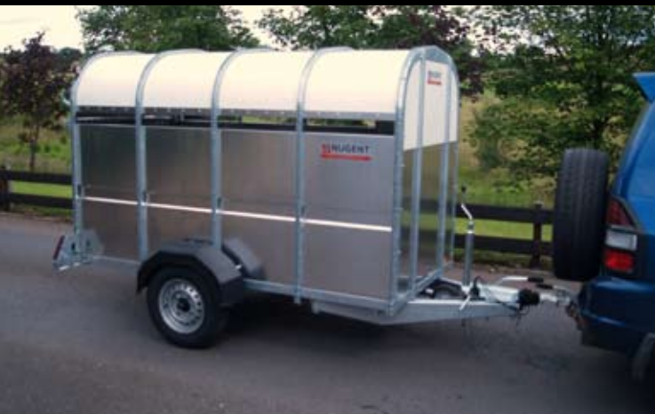
Ventilatie openingen aan beide zijken trailer
